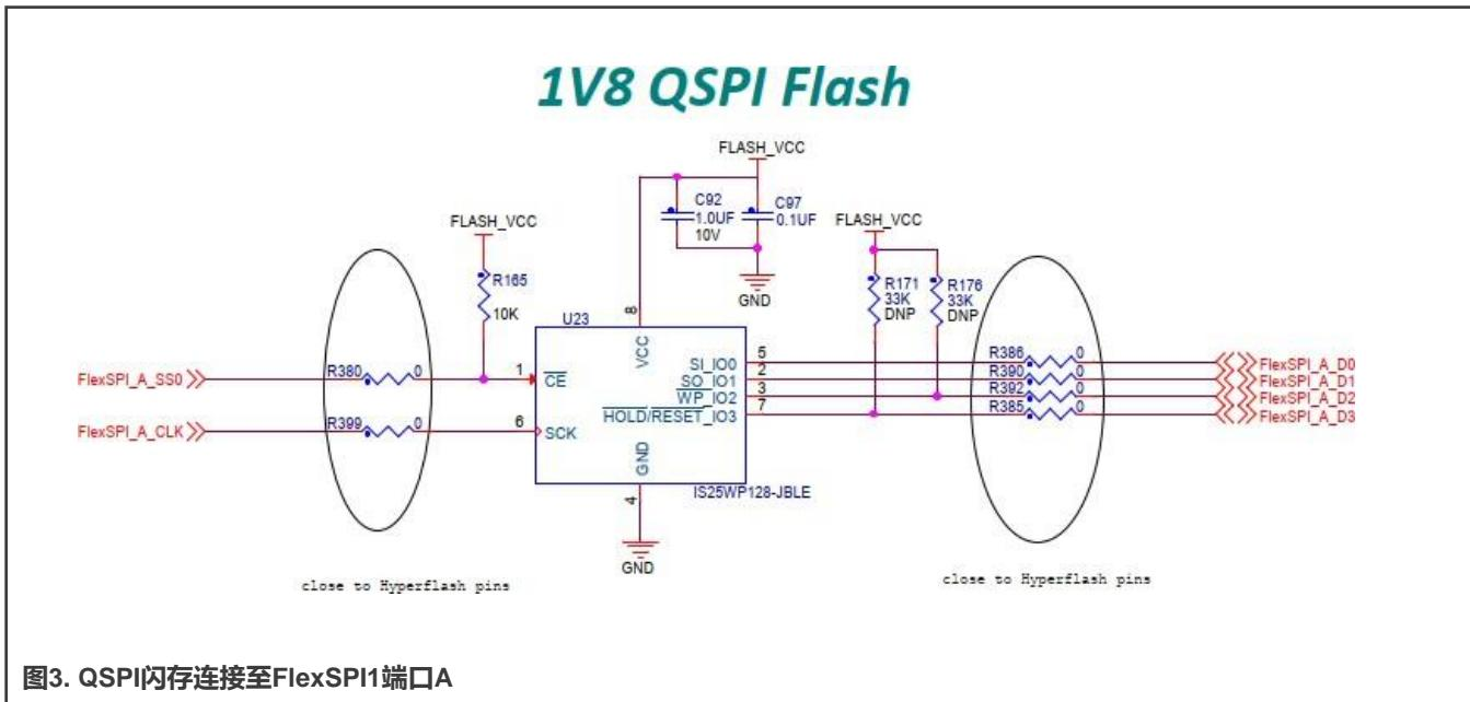
图3. QSPI闪存连接至FlexSPI1端口A
