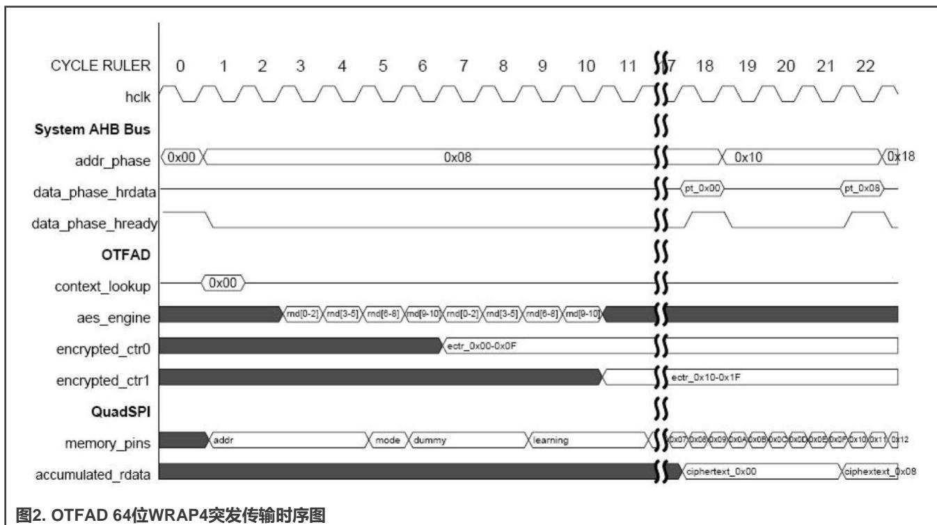
图2. OTFAD 64位WRAP4突发传输时序图
