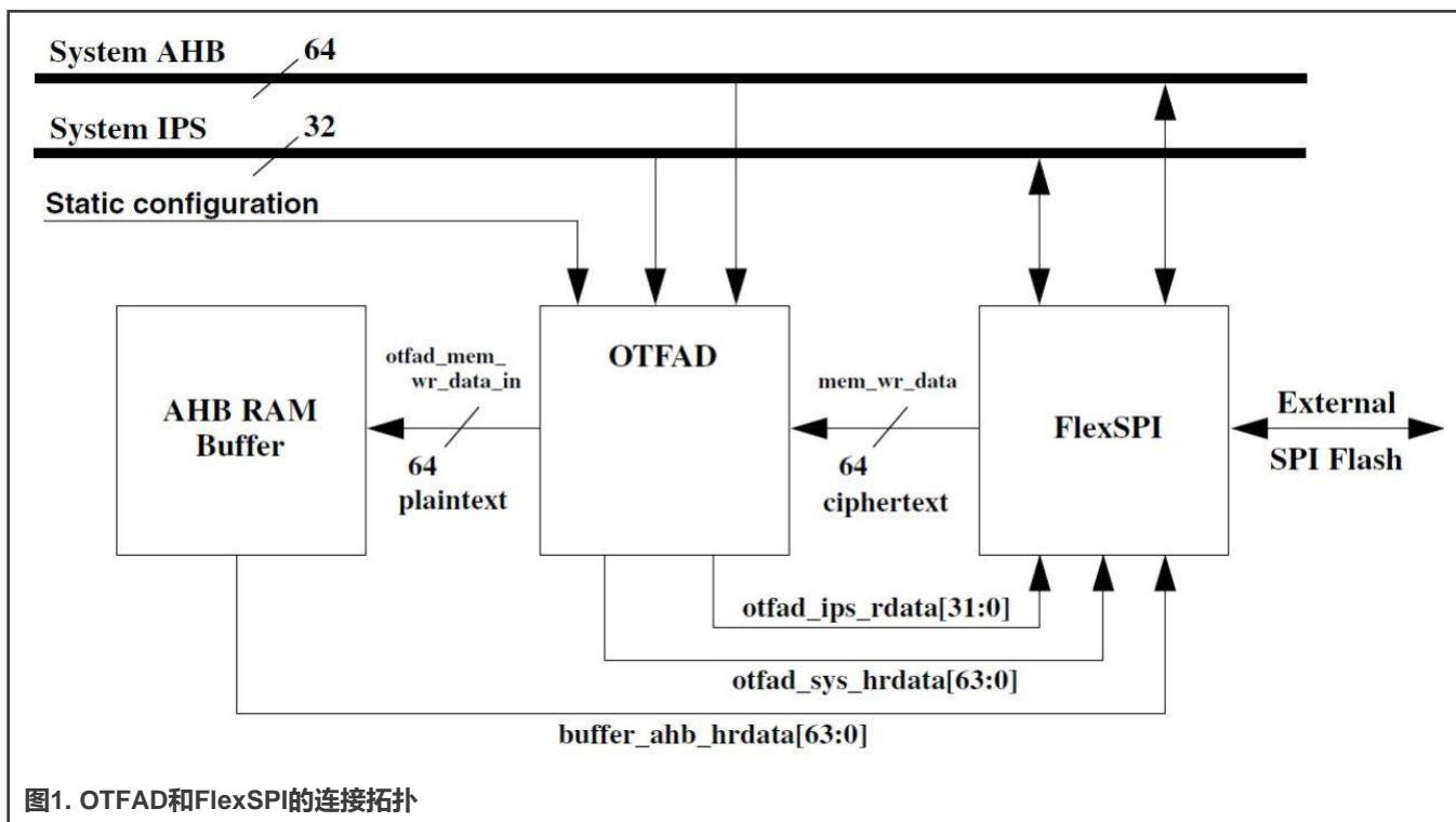
图1. OTFAD和FlexSPI的连接拓扑
